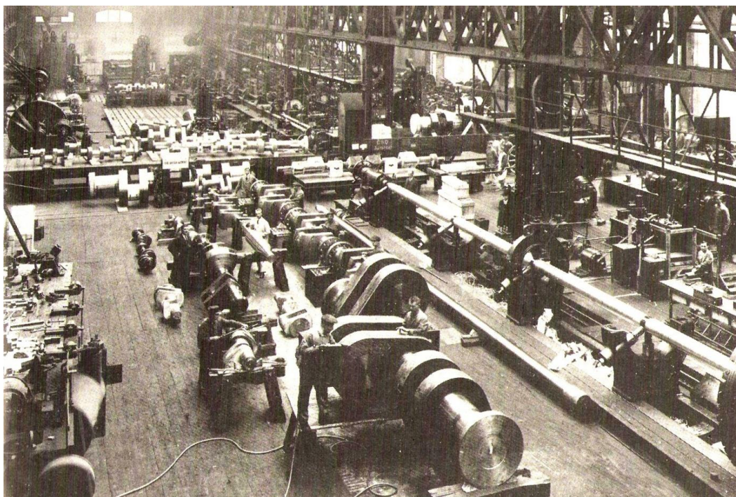
Zalomené hřídele se ve velkém měřítku vyráběly pro švýcarskou Firmu Schulzer, která je dodávala do celého světa
