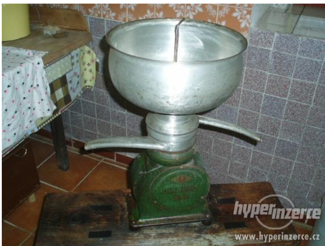
Odstředivka - toto je také jiný typ. Do mísy se nalilo mléko a z jedné hubice vytékalo odstředěné mléko a z druhé smetana. Jako kluci jsme točili klikou a tím
